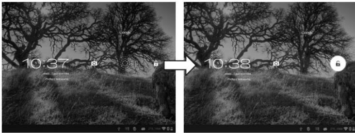
*Wyłączanie:* Gdy tablet jest włączony, wciśnij i przytrzymaj przez ok. 4 sec. przycisk zasilania, po czym na ekranie pojawią się opcje wyłączania, wybierz “Wyłącz”, a następnie potwierdź wybór, a tablet się automatycznie wyłączy.
