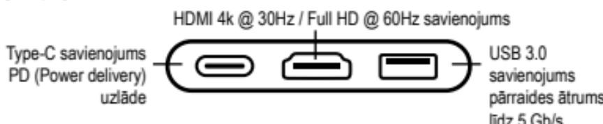
**HDMI darbojas tikai tad, ja adapteris ir pievienots USB-C ligzdai, kas atbalsta PD. PD ports ir paredzēts tikai uzlādei.**
