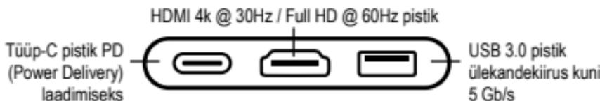
**HDMI töötab ainult juhul, kui adapter on ühendatud PD-d toetava USB-C pistikuga. PD-port on mõeldud ainult laadimiseks.**
